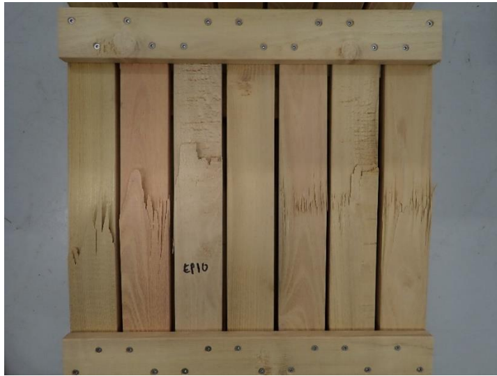
Figure 5. Vue en dessous des éprouvettes après rupture
