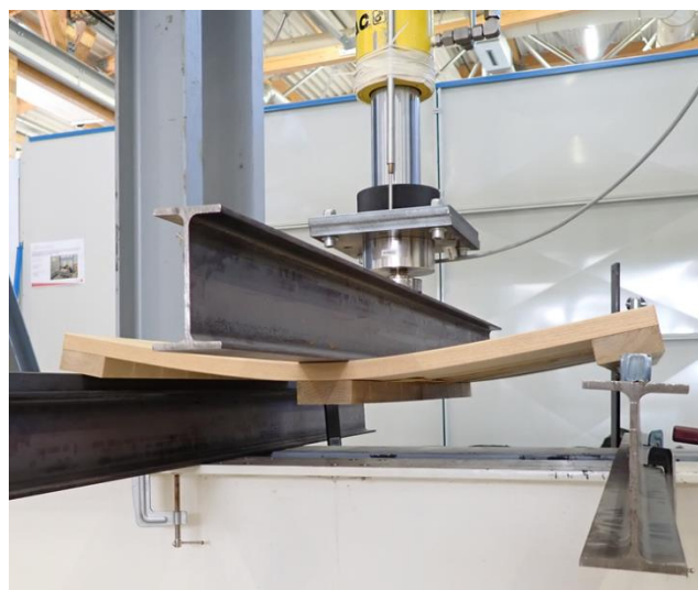
Figure 4. Rupture en flexion des éprouvettes.
