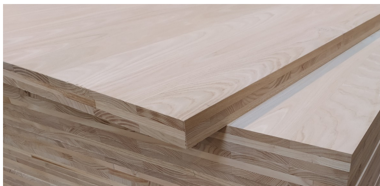
Panneau trois plis de châtaignier, épaisseur 42 mm, (3 plis identiques de 14 mm)
