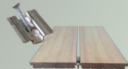
La fixation brevetée B-Fix s'insère dans la rainure par le chant avant ou arrière de la terrasse jusqu'à la lambourde. Le vissage se fait par le dessus, et devient quasi invisible une fois l'ouvrage terminé.
